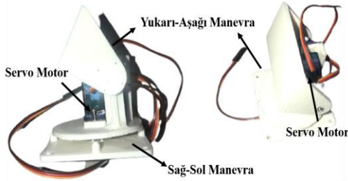
Fig. 214. Üretilmiş Mekanik Parçaların Montajı
